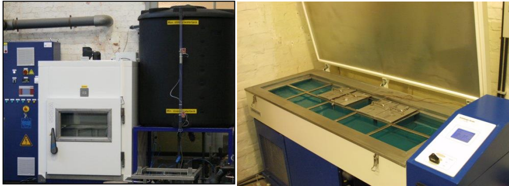
A gauche : frigo pour gel interne (refroidissement à l'air et réchauffement à l'eau) ; A droite : frigo pour essai CF-CDF refroidi au glycol.
