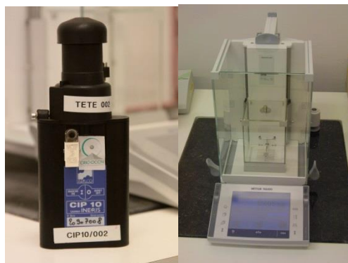
A gauche Capteur Individuel de Poussière CIP 10 ; A droite balance de ultrahaute précision ( \mu\text{g} ).
